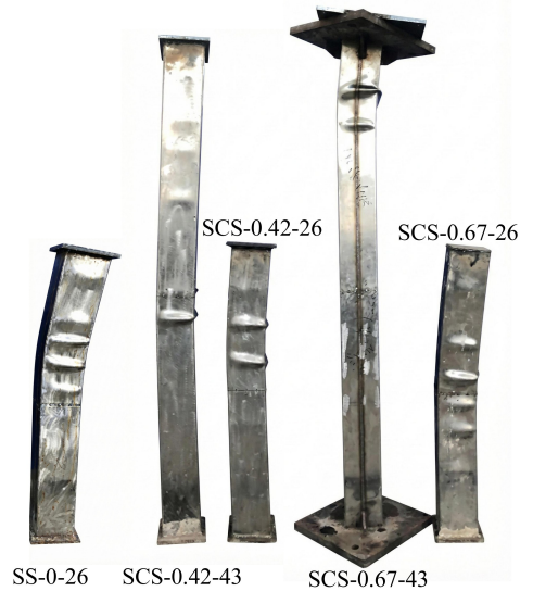
图 4 所有试件的破坏形态
