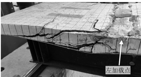
图 6 试验梁破坏形态
