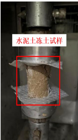
图 2 冻结水泥砂土压缩试验过程图
