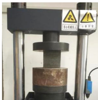
图 1 立方体抗压试验
