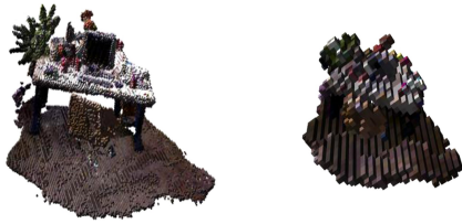
(c) 分辨率 0.1 像素/m 的八叉树地图 (d) 分辨率 0.5 像素/m 的八叉树地图
