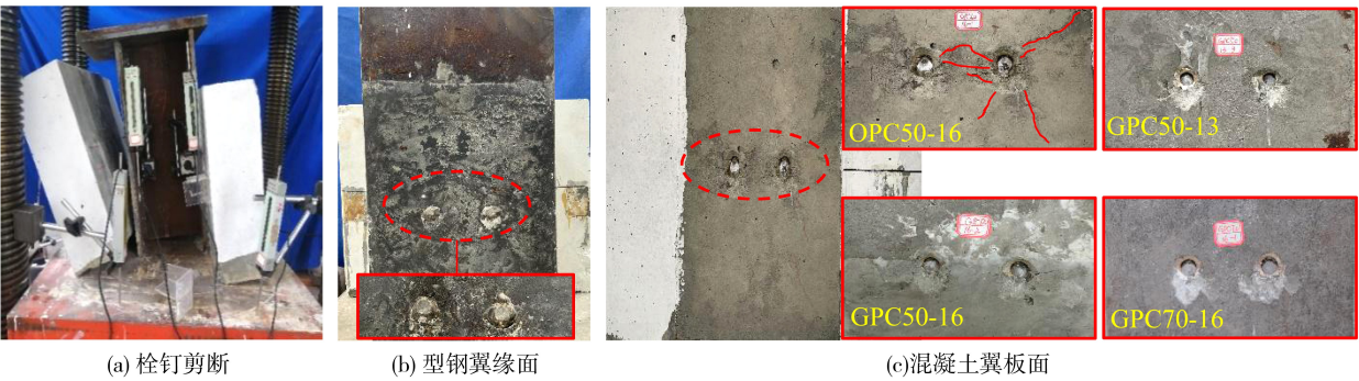
图 3 试件典型破坏模式 Fig.3 Typical failure mode
