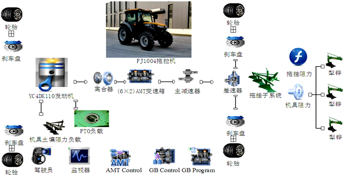
图 2 整车动力系统模型 Fig.2 Vehicle power system model
