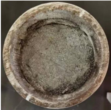
图 5 加载面 HPC 成块脱落
