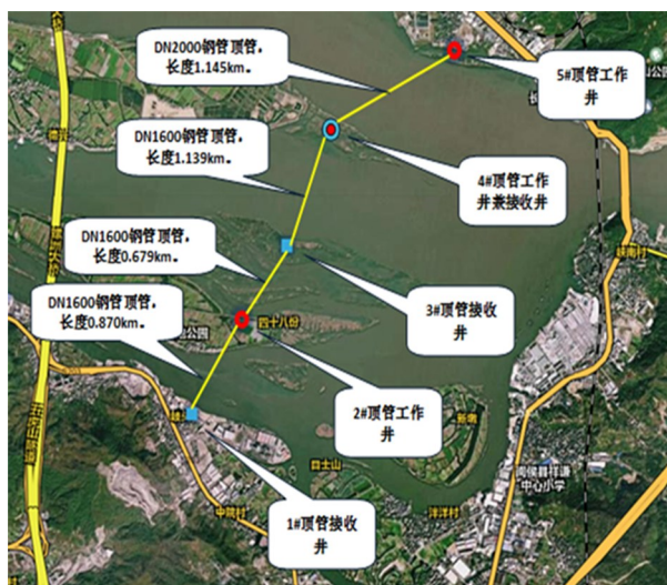
图 1 穿越乌龙江顶管施工平面图
