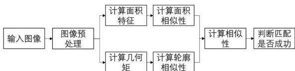
图2 改进几何矩匹配算法流程图
