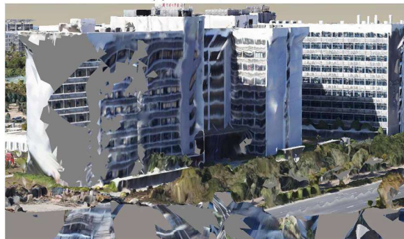
(c) 存在破洞且表面玻璃模糊的模型
