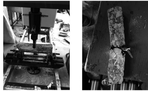
图 1 小梁弯曲试验及其试件 Fig.1 Trabecular bending test and the test piece
