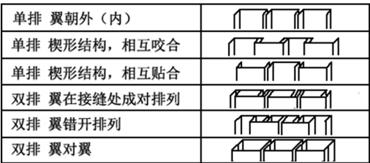
图 2 U 型玻璃外墙构造类型
