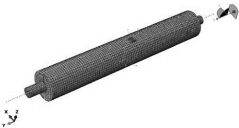
图 4 模型网格的划分 Fig.4 Meshing of the model
