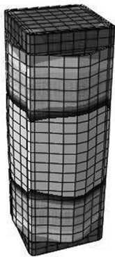
图 3 STCC-1 构件破坏形态
