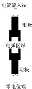
图 2 电极结构示意图 Fig.2 A schematic view of the electrode structure
