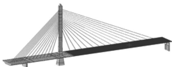
图 2 MIDAS/Civil 全桥模型
