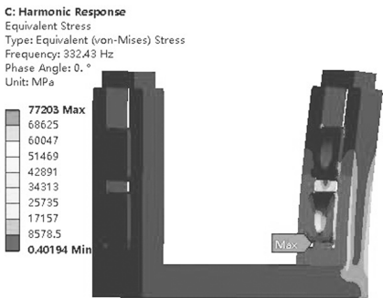
(a) 第 1 阶固有频率下的应力响应分布
