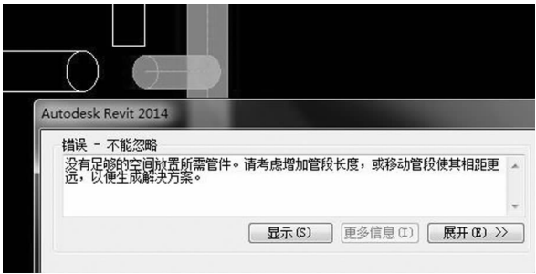
图 5 没有足够空间放置管件 Fig.5 Limited space for pipe components
