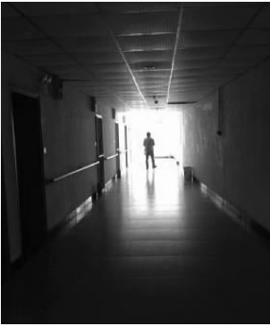
图 6 产生眩光的走道设计 Fig.6 The corridor design producing glare effect
