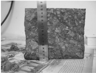
图 4 高性能混凝土劈裂面 Fig.4 Split surface of high performance concrete
